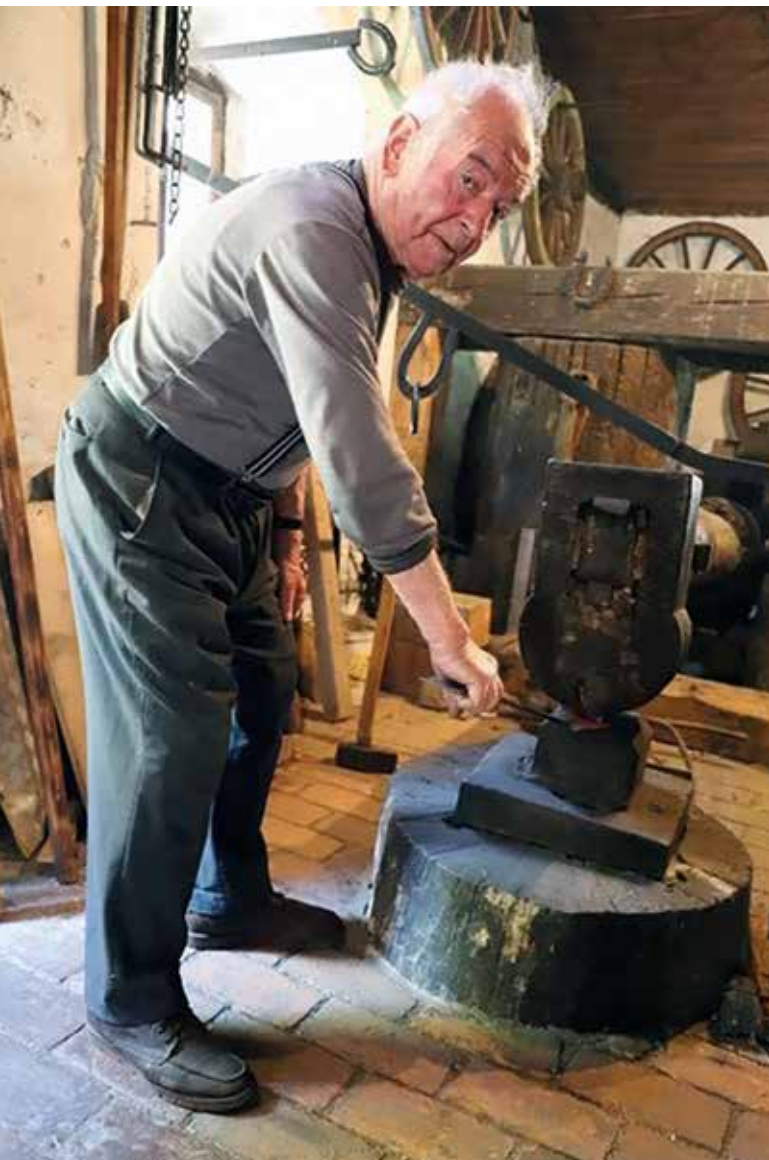
> Zwischen wassergetriebenem Hammerkopf und Amboss formt Huber seine Glücksnägel.
